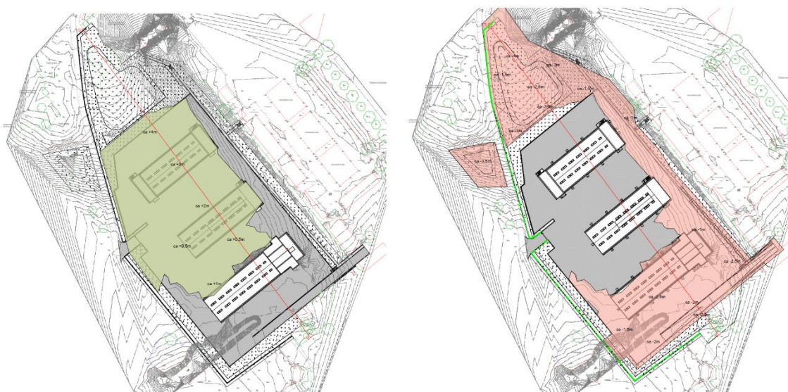
Figur 2 –skitse over hvor terrænet hæves (grøn) og terrænet sænkes (rød)
